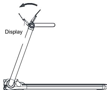
Zusammenklappen des Computers von der Matte: Halten Sie den Computer mit beiden Händen, schieben Sie ihn mit leichtem Kraftaufwand nach vorne und drehen Sie ihn.
