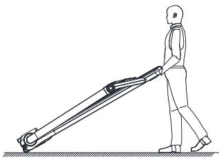
Der Benutzer steht an der Rückseite des Laufbandes, greift mit beiden Händen die Querstange auf der Rückseite des Laufbandes, hebt sie um 35° an, schiebt das Laufband an eine geeignete Stelle und legt es flach hin. Um Unfälle bei der Nutzung der Matte zu vermeiden, sollte hinter der Matte eine Sicherheitszone von mindestens 2000 mm × 1000 mm reserviert werden.
