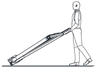
El usuario se para en la parte trasera de la máquina para correr, agarra la barra transversal en la parte posterior de la máquina para correr con 2 manos, la eleva 35°, empuja la máquina para correr a un lugar adecuado y la coloca plana. Detrás de la alfombra se debe reservar una zona de seguridad de al menos 2000 mm × 1000 mm para evitar accidentes al utilizarla.
