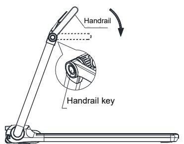
De mat opvouwen: Terwijl u de mat iets optilt, drukt u op de knop aan de zijkant. Op dit moment kan de hand draaien en na een bepaalde hoek te hebben gedraaid, kan de knop worden losgelaten en na op zijn plaats te hebben gedraaid, zal deze een "klik"-geluid, wat aangeeft dat het op zijn plaats is vergrendeld.
