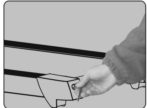
2) De loopband is in de fabriek afgesteld, het kan zijn dat deze na transport of gebruik niet goed werkt. Stop de loopband voor het afstellen, trek de loopband naar het midden en stel de bouten van de linker en rechter achterrol af met een inbussleutel (zie figuur). Het is aan te bevelen om een halve slag per keer af te stellen.
