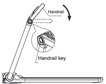
Falten der Matte: Während Sie die Matte leicht anheben, drücken Sie den Knopf an der Seite. Zu diesem Zeitpunkt kann sich die Hand drehen. Nach dem Drehen um einen bestimmten Winkel kann der Knopf losgelassen werden, und nach dem Drehen an Ort und Stelle wird eine Drehung ausgeführt. Ein „Klick“-Geräusch zeigt an, dass es eingerastet ist.
