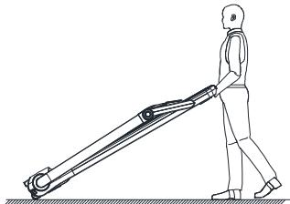
L'utilisateur se tient à l'arrière du tapis, saisit la barre transversale à l'arrière du tapis avec les 2 mains, la soulève de 35°, pousse le tapis de course jusqu'à un endroit approprié et le pose à plat. Une zone de sécurité d'au moins 2 000 mm × 1 000 mm doit être réservée derrière le tapis pour éviter les accidents lors de l'utilisation du tapis.
