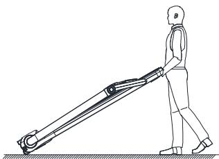
L'utente si trova nella parte posteriore del tapis roulant, afferra la barra trasversale sul retro del tapis roulant con 2 mani, la solleva di 35°, spinge il tapis roulant in una posizione adatta e lo adagia. Dietro il tappeto deve essere riservata una zona di sicurezza di almeno 2000 mm × 1000 mm per evitare incidenti durante l'utilizzo del tappeto.
