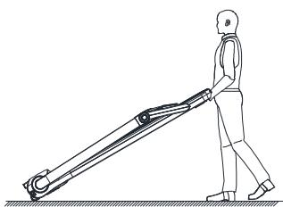
De gebruiker staat aan de achterkant van de loopband, pakt de dwarsbalk aan de achterkant van de loopband met 2 handen vast, tilt deze  $35^\circ$  op, duwt de loopband naar een geschikte locatie en legt deze plat. Achter de mat moet een veiligheidszone van minimaal 2000 mm  $\times$  1000 mm worden gereserveerd om ongelukken bij het gebruik van de mat te voorkomen.
